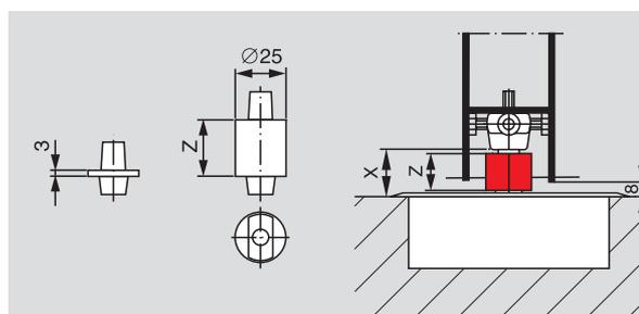
Возможно использование специальных шпинделей: с плоским профилем и угловым смещением в 3° или квадратным сечением. Шпиндели для использования с дверными аксессуарами иных, чем DORMA производителей, также доступны.
